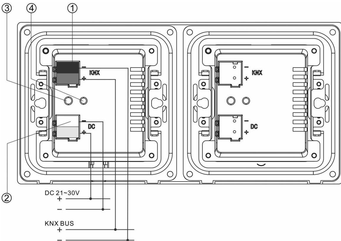
① KNX 总线接线端子      ② 辅助供电接线端子      ③ 编程按键
